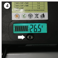
Battery voltage (20 - 26,6) Volt
